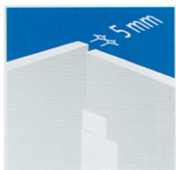
Spoj dvije sječene ploče ili spoj ploče i masivnog zida gletuje se i bandažira samo sa strane jedne gipskartonske ploče.
